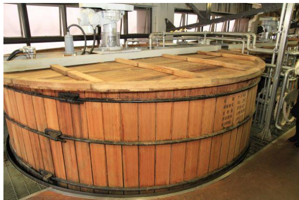
サントリー山崎蒸溜所の木桶発酵槽。1989年、当時の常識を覆して木桶発酵槽を再導入、良質な原酒確保に邁進する
