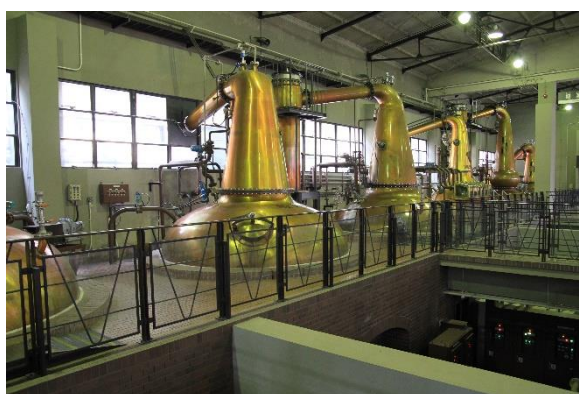
さまざまな形状の蒸溜釜が多様なモルト原酒を生み出す
